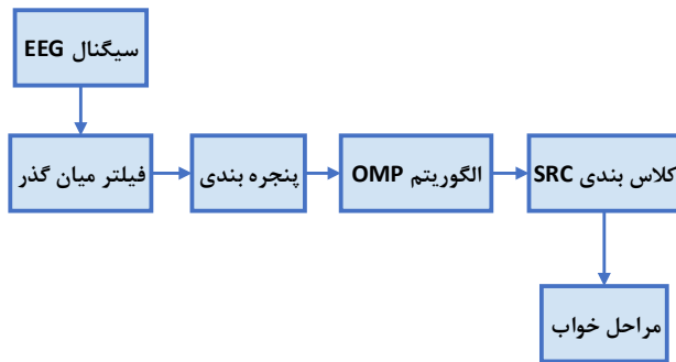
شکل ۲: کلاس‌بندی مراحل خواب با کلاس‌بندی نوع SRC بر اساس الگوریتم OMP پیشنهادی
