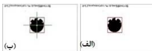
شکل ۵: الف) مربع احاطه‌کننده و مماس بر دایره مردمک، ب) تقسیم طول و عرض مربع بر دو و تشخیص مرکز مردمک
