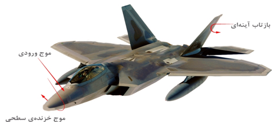
شکل ۴: بازتاب آینه‌ای و برگشتی امواج خزنده از سطوح استوانه‌ای یا کروی شکل دماغه و بدنه‌ی هواپیما
