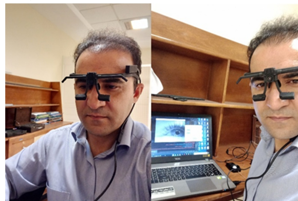
شکل ۸- شکل ظاهری دوربین مورد استفاده برای تهیه مجموعه داده و نحوه اتصال به سر ناظر
