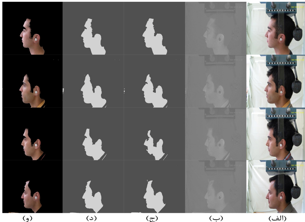
شکل ۶: بخش‌بندی پوست چهره بر روی تصاویر نمای روبروی پایگاه داده‌ی دانشگاه صنعتی سهند. (الف): تصویر نمای جانبی چهره، (ب): فضای کرومینانس، (ج): بخش‌بندی تصویر براساس الگوریتم SOM استاندارد پس از پس‌پردازش، (د): بخش‌بندی تصویر براساس الگوریتم پیشنهادی پس از پس‌پردازش، (و): ماسک نهایی چهره.
